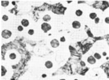
**GHISA GS-500** : Ghisa SFEROIDALE con struttura perlitica - ferritica, quindi molto resistente e durevole.
