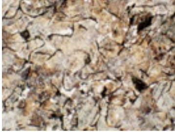
**GHISA G25** : Ghisa IDRAULICA che possiede una buona combinazione di durezza e resistenza. Presenta una buona lavorabilità e una grana molto fine che danno ai particolari finiti di lavorazione una buona finitura.
