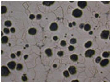
**GHISA GS-400** : Ghisa SFEROIDALE con una struttura ferritica ottenuta con un trattamento termico.
